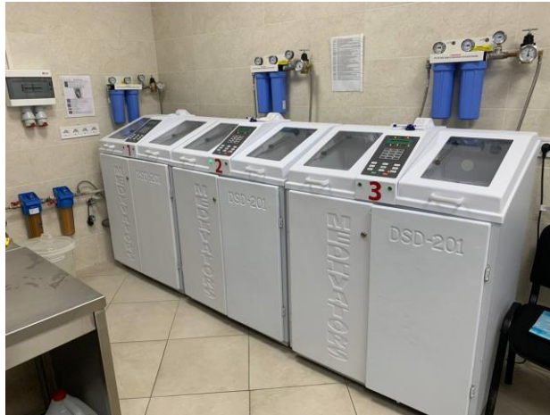
Автоматичний ендоскопічний репроцесор з двома резервуарами DSD-201LT – 2 шт. ВП «Лікарня Святого Пантелеймона»
