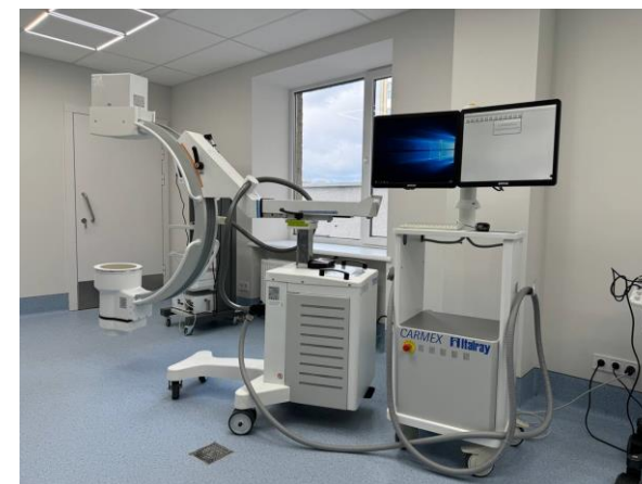
Система флюороскопічна рентгенівська
