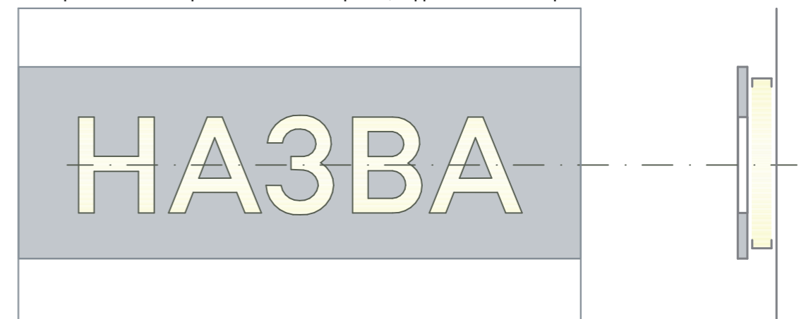
Площина вивіски з різьбленими літерами, підсвіченими на фоні
