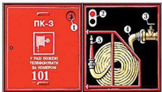
Рисунок 2. Внутрішній пожежний кран: 1 – місце зберігання ключа; 2 – пульт дистанційного запуску насоса-підвищувача; 3 – пожежний кран; 4 – пожежний рукав; 5 – ствол.
